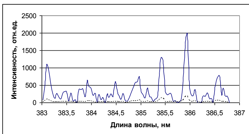
Рисунок 1 – Зависимость изменения интенсивности атомных и ионных линий U от величины временных интервалов между импульсами: — 6 мкс; ... 0 мкс
